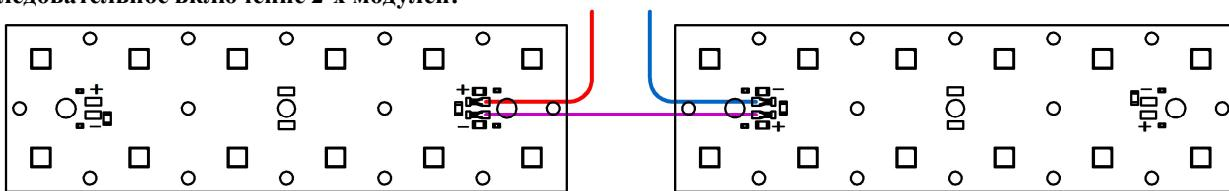
Параллельное включение 2-х модулей:
