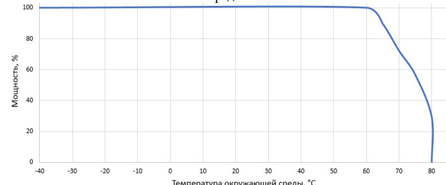
Зависимость мощности при максимальной нагрузке от температуры точки Тс.
