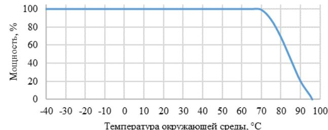
Зависимость мощности при максимальной нагрузке от температуры точки T<sub>с</sub>.
