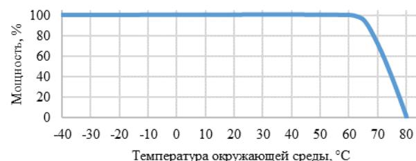
Зависимость мощности при максимальной нагрузке от температуры точки T<sub>c</sub>.
