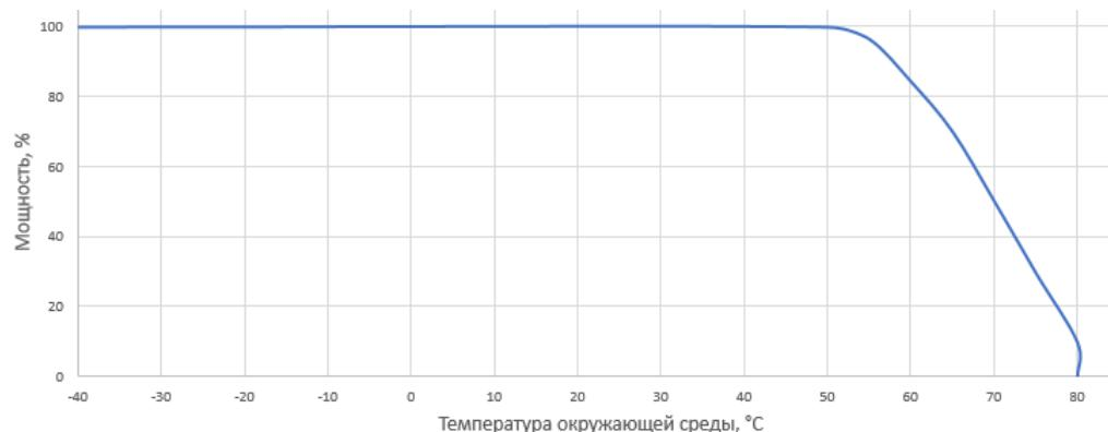
Зависимость мощности при максимальной нагрузке от температуры точки Tс.
