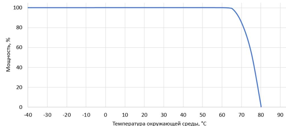
Зависимость мощности при максимальной нагрузке от температуры точки Тс.
